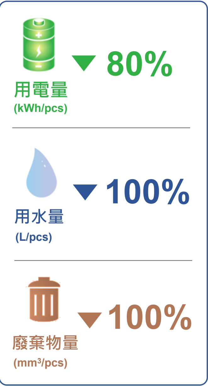
晶圓切割技術由「傳統刀具切割」轉換成「隱形雷射切割」
